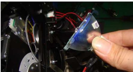
7. Installieren Sie die neue Lampe entsprechend der umgekehrten Reihenfolge.
