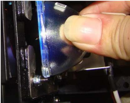
6. Die Lampe lässt sich nun entnehmen, lösen Sie jetzt noch die Kabel der Lampe und Sie können sie entnehmen.
